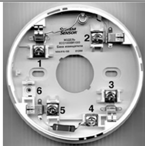
Рис. 1. Расположение контактов базы E1000R
