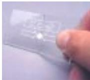
В извещателях WR2001/SR и WR2072/SR-470 стекло при выдавливании разламывается. Стекло имеет определенную структуру и покрыто защитной пластиковой пленкой, благодаря чему разрушение стекла происходит строго в определенном месте и не сопровождается появлением острых краев и осколков, опасных для человека, активизирующего ИПР. Обратное включение данных ИПР в дежурный режим производится путем установки в извещатель нового стекла.
