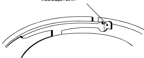
Рис. 3а. Активизация функции защиты от несанкционированного извлечения извещателя
