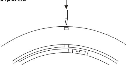
Рис. 3б. Извлечение извещателя из базы после активизации защиты
