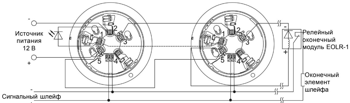
Рис. 2б. Типовая 4-х проводная схема подключения
