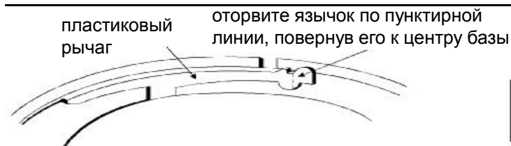
Рис.3а. Активизация функции защиты от несанкционированного извлечения извещателя
