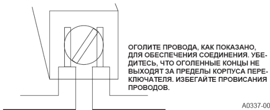
Рис. 4. Подключение проводников к терминалу
