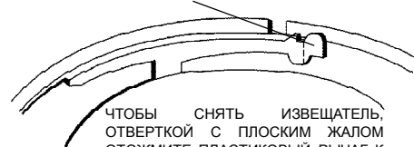
Рис.2. Защита от несанкционированного извлечения извещателя
