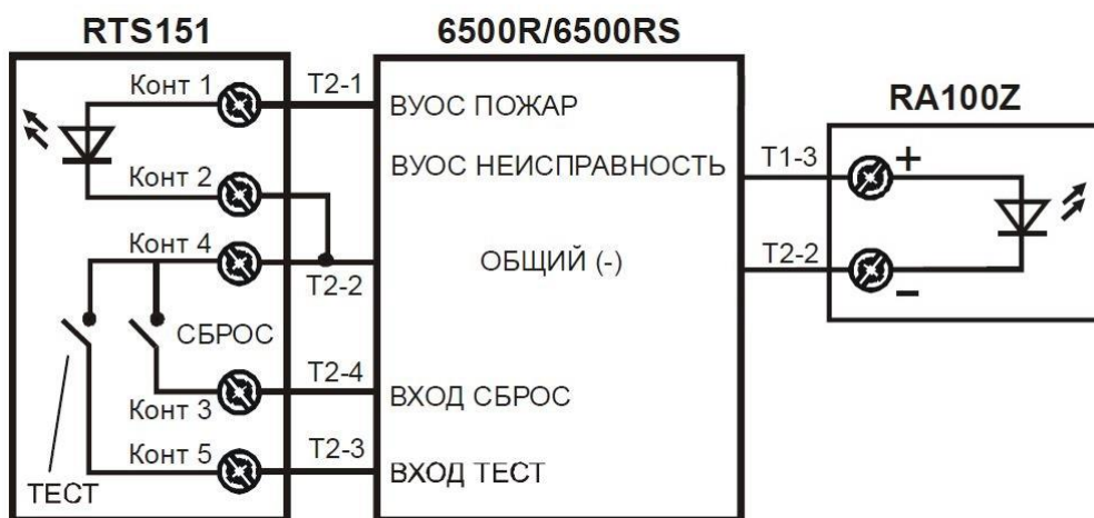
Рис. 4б Схема подключения пульта RTS151 с RA100Z
