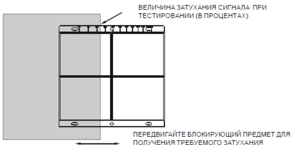
Рис. 10. Процедура тестирования затенением рефлектора
