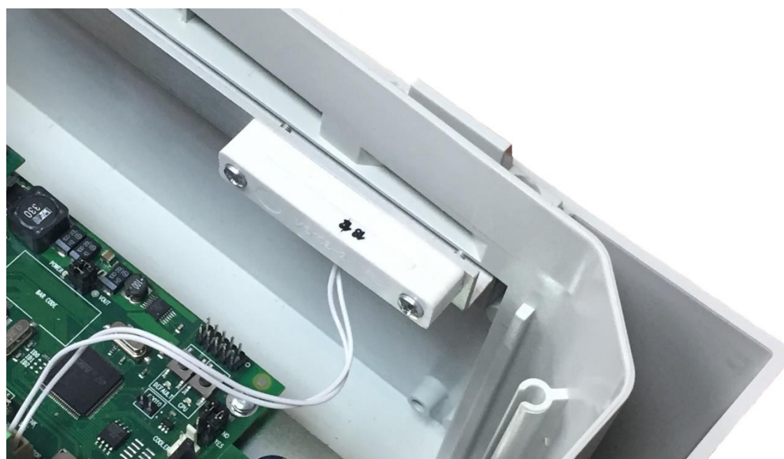
Рисунок 3.6.2 - Датчик вскрытия на корпусе коммутатора
