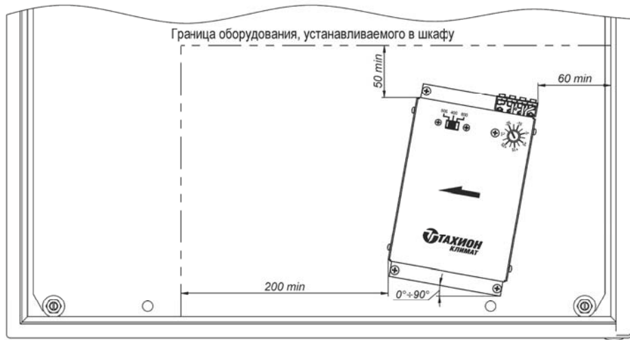
Рис.2 Пример установки на монтажной панели шкафа
