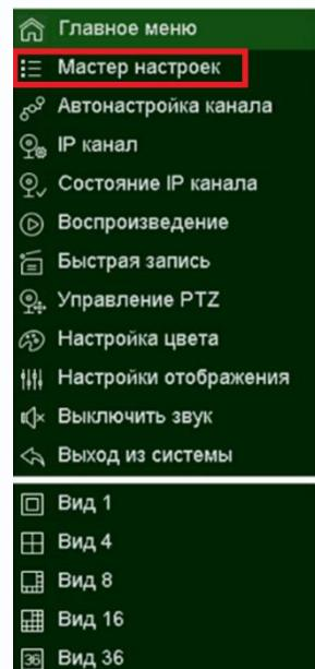
Мастер настроек автоматически запускается при включении регистратора, для отмены запуска мастера настроек снимите галочку **Включить**. Для отмены запуска мастера настроек после перезагрузки снимите галочку **Мастер настроек** в меню **Основные**.
