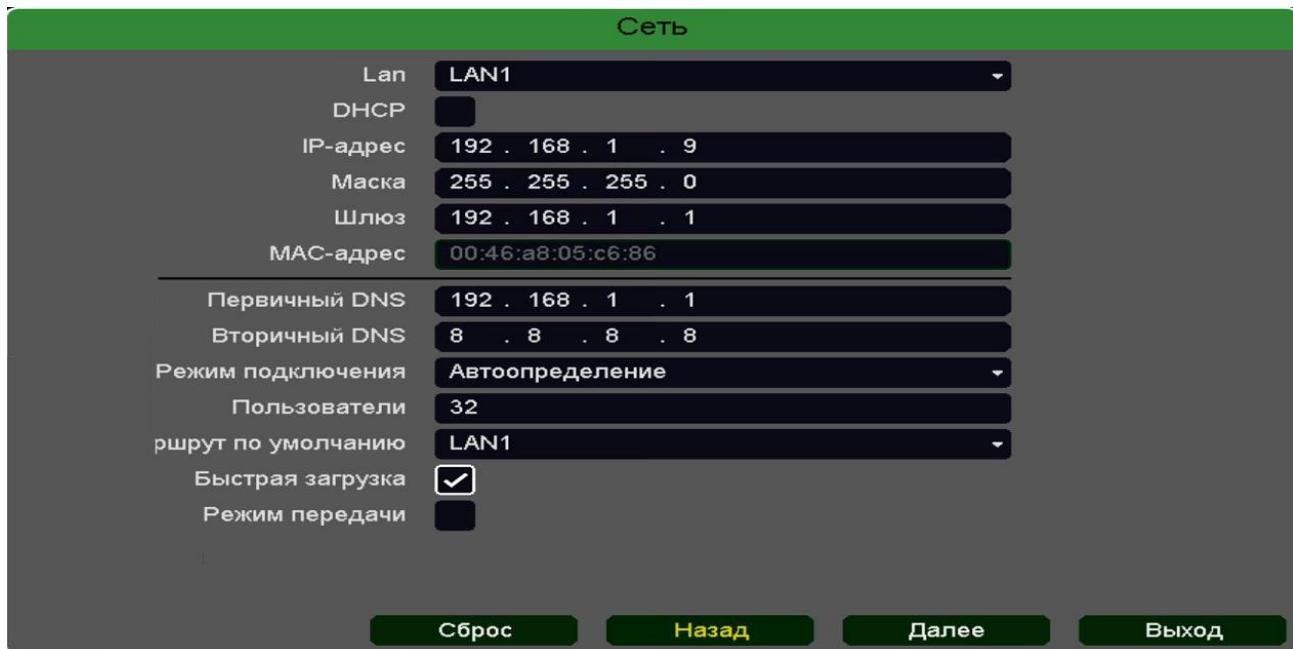
Можно задать получение адреса регистратором от DHCP (при этом необходимо, чтобы сервер DHCP был в сети) сервера при установке параметра **DHCP**, либо вручную.
