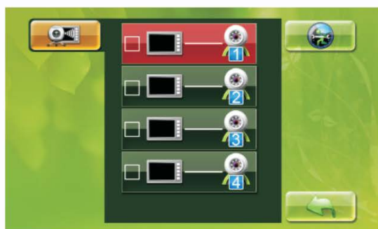
4.9. Регистрация панели. Выберите канал, нажмите ОК, замкните контакты «Регистрация» в вызывной панели.
