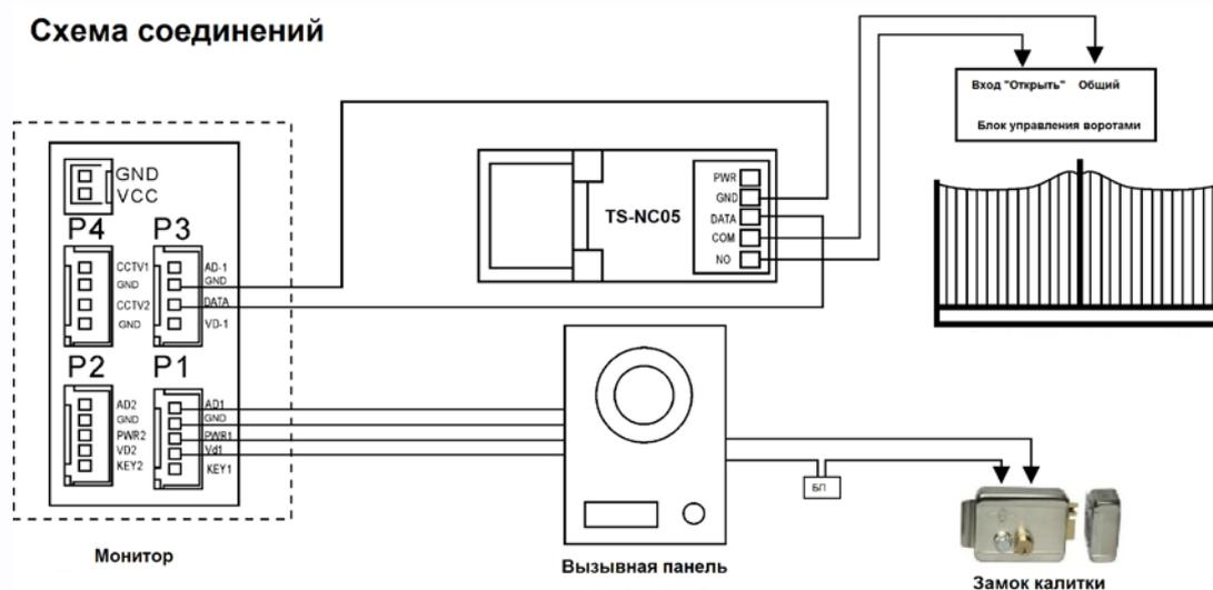
**Внимание:** при подключении электронного реле к блоку управления воротами требуется соблюдать полярность. Запрещается подключать устройства имеющие потребляемый ток выше 5мА.
