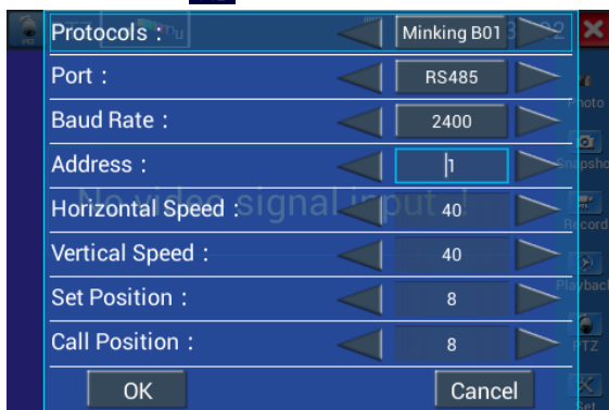
Рис.3.3.1-2 Окно настройки протокола управления камерой (RS485)
