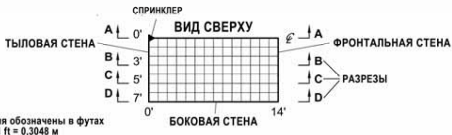
Рис. D. Вертикальный срез зоны орошения на разных боковых удалениях от оросителя
