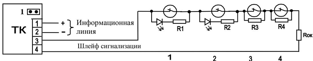
Рис.2. Схемы подключения к шлейфу сигнализации адресной метки: (1), (3) - извещателей с раздельной выдачей сигналов «Внимание» и «Пожар»; (2),(4) –извещателей с выдачей сигнала «Пожар», например, ручных извещателей.
