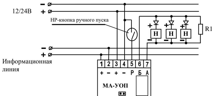
Рис.2. Схема подключения устройств пожарной автоматики или оповещения. Для напряжения питания 24В:  $R1 = 10 \text{ кОм} \pm 5\%$ , для 12В:  $R1 = 5,6 \text{ кОм} \pm 5\%$ .
