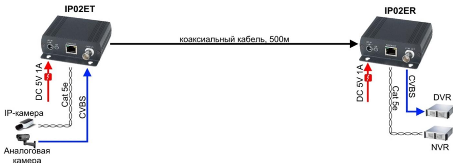
Рис.3 Схема подключения комплекта IP02E
