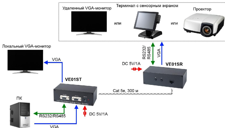
Рис.5 Схема подключения VE01S
