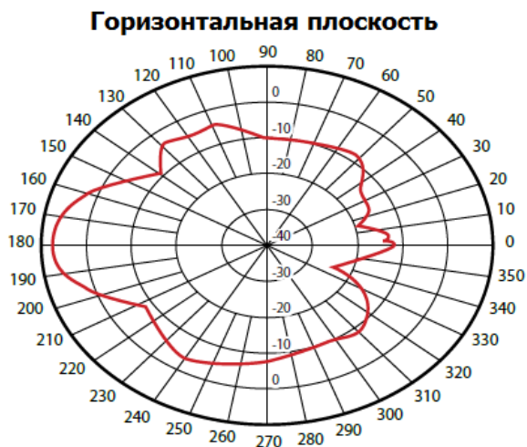
Рис.2 Диаграмма направленности антенны АТ-5.8/Patch(7) в горизонтальной плоскости.
