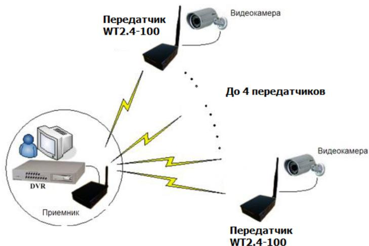
Рис.3 Схема подключения (несколько передатчиков – один приемник)
