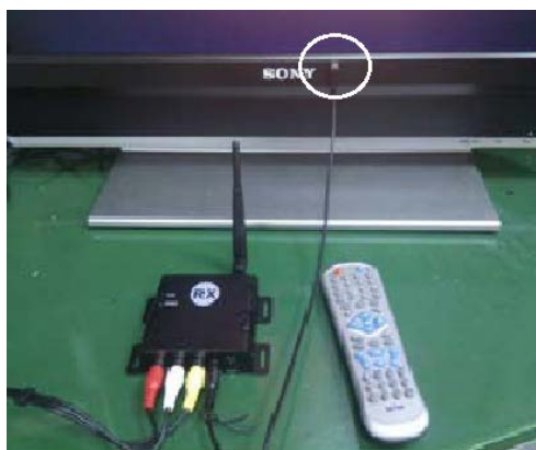
Рис.9 Подключение ИК-излучателя к ИК-порту монитора.
