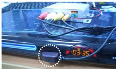
Рис.8 Подключение ИК-излучателя к ИК-порту DVD-проигрывателя.
