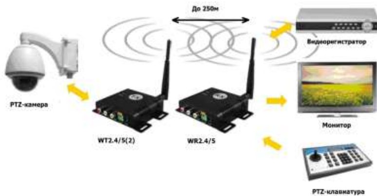
Рис.4 Схема подключения передатчика WT2.4/5(2) и приёмника WR2.4/5.
