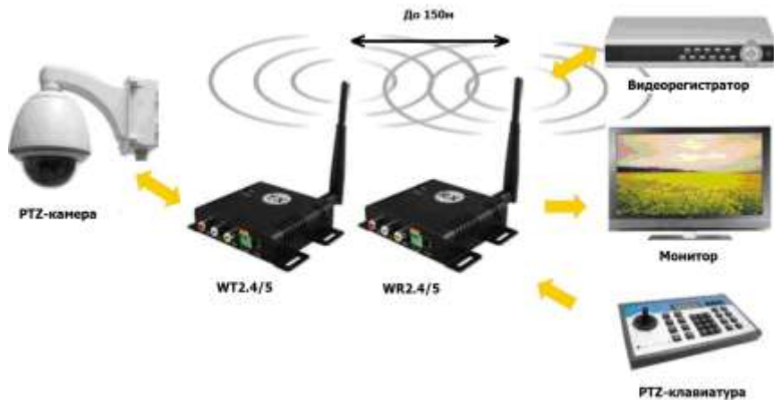
Рис.3 Схема подключения передатчика WT2.4/5 и приёмника WR2.4/5.
