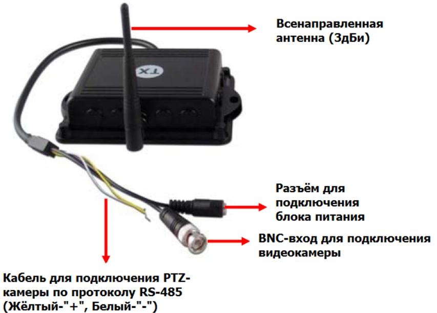
Рис.4 Панель подключения WT2.4/5(W).
