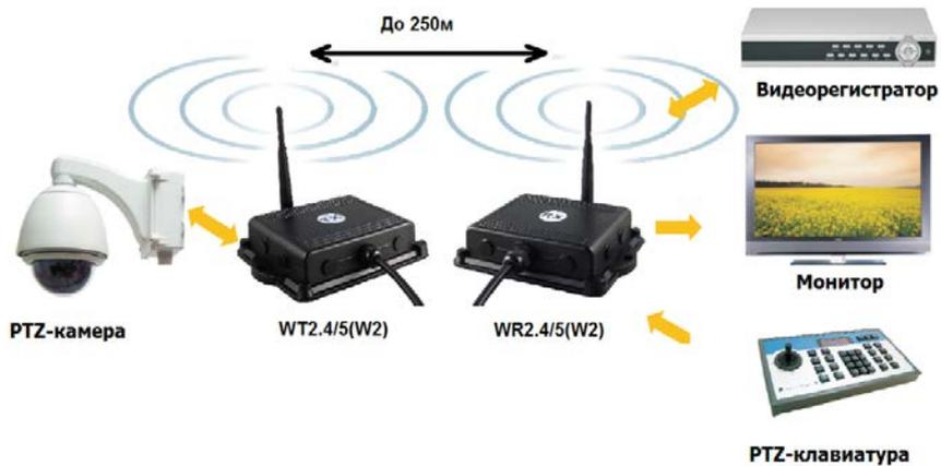
Рис.4 Схема подключения передатчика WT2.4/5(W2) и приёмника WR2.4/5(W2).
