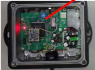
Рис.8 Расположение DIP-переключателя внутри устройства.
