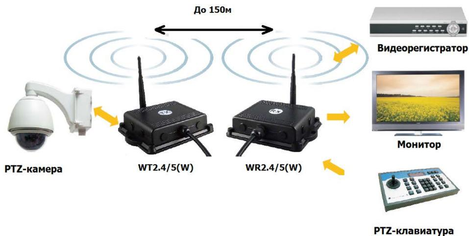
Рис.3 Схема подключения передатчика WT2.4/5(W) и приёмника WR2.4/5(W).
