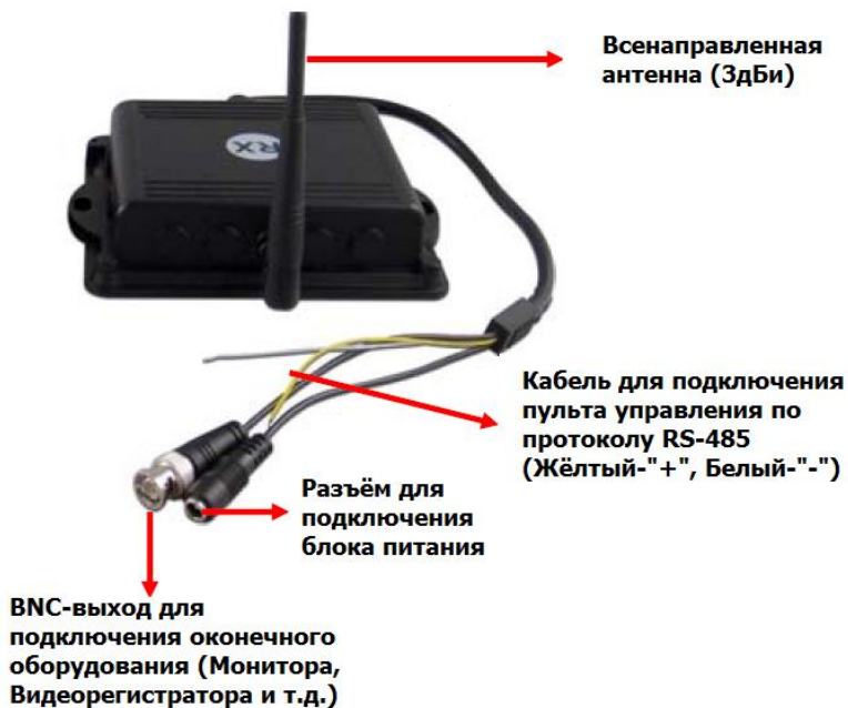
Рис.5 Панель подключения WR2.4/5(W).
