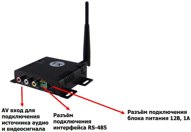
Рис.5 Передняя часть панели подключения WT2.4/5 / WT2.4/5(2).
