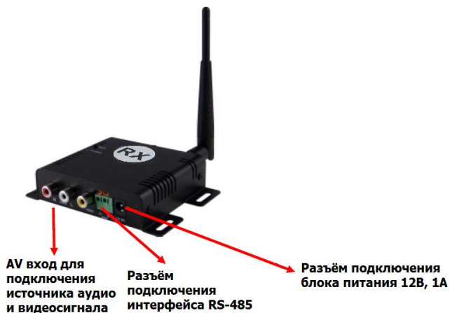
Рис.7 Передняя часть панели подключения WR2.4/5.
