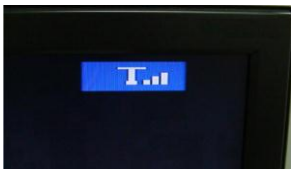
Рис.9 Отображение уровня сигнала на экране монитора.
