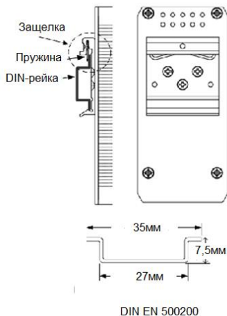
Рис.7 Монтаж коммутатора SF-40602/IB на DIN-рейку.
