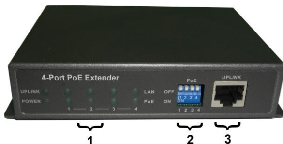
Рис.3. Удлинитель SW-20500/DB , вид спереди
