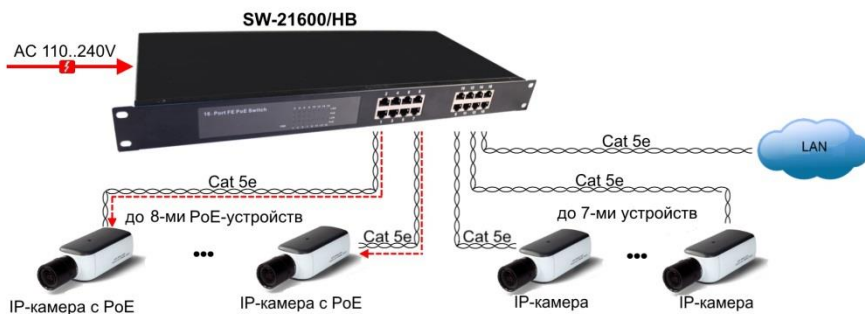
Рис. 4 Схема подключения коммутатора SW-21600/HB
