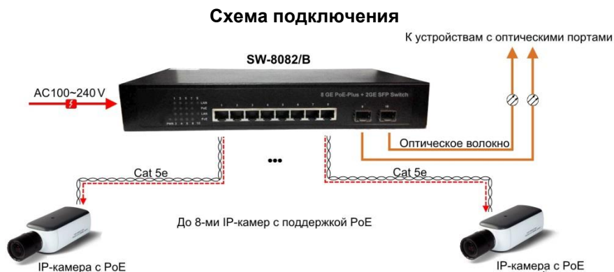
Рис. 3 Схема подключения коммутатора SW-8082/B
