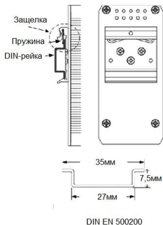
Рис.7 Монтаж коммутатора SF-30602/I на DIN-рейку.
