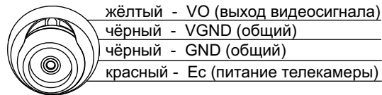
Рисунок 4 - Цвет и назначение проводов
