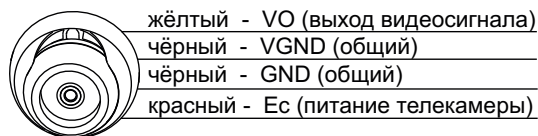
Рисунок 4 - Цвет и назначение проводов телекамеры ODC-701-3.6
