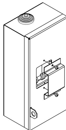
Рисунок 5 – Установка защитной скобы на дверцу бокса
