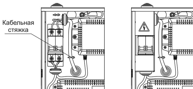
Рисунок 4 – Подключение к автоматическому выключателю сетевых шнуров и кабеля питающей сети, при вводе его в бокс через кабельный ввод на задней стенке бокса
