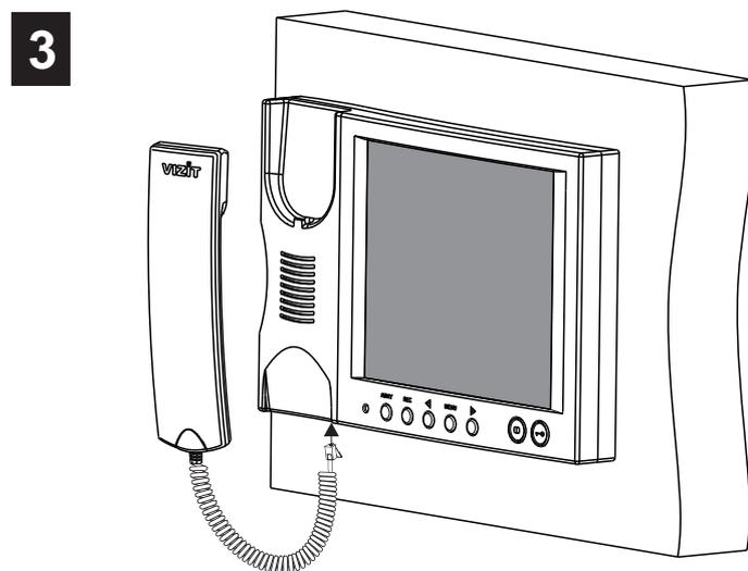
Рисунок 3 - Порядок установки терминала с использованием монтажной пластины
