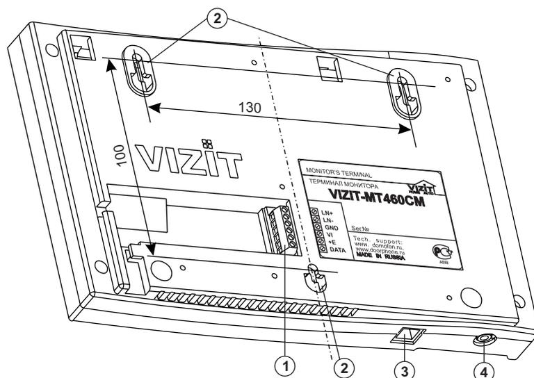
1. Клеммы для подключения терминала к блоку коммутации
