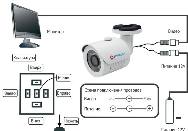
Данная камера имеет три режима работы с разрешением 2Мп: TVI, AHD и CVI, а также режим аналогового видео стандарта CVBS (PAL 960H) с разрешением 700ТВЛ. По умолчанию камера работает в стандарте TVI. Для переключения в другие режимы удерживайте кнопку ВНИЗ на OSD-джойстике: в течение первых 5-ти секунд камера переключится в режим AHD, при дальнейшем удержании в течение 5-ти секунд - в режим CVI, еще через 5 секунд - в режим CVBS.
