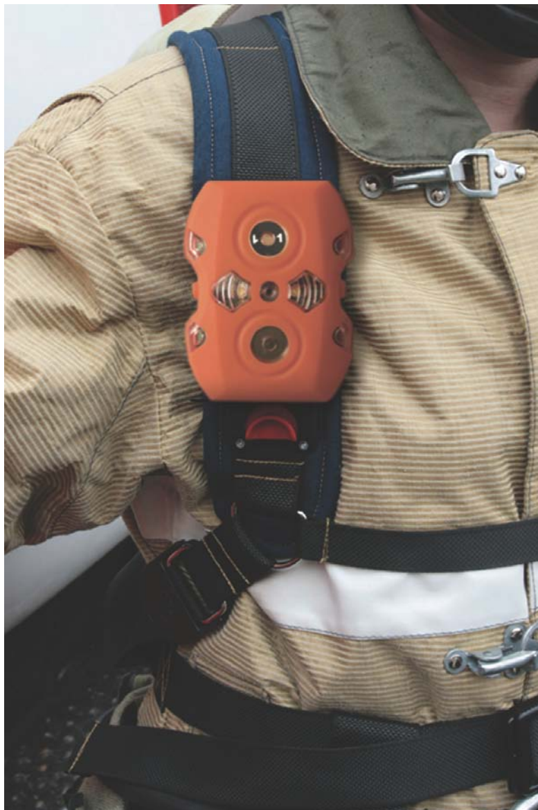
Рисунок ГЗ Пример установки МС в крепежное устройство КУ-1 или КУ-2 (на лямке дыхательного аппарата)
