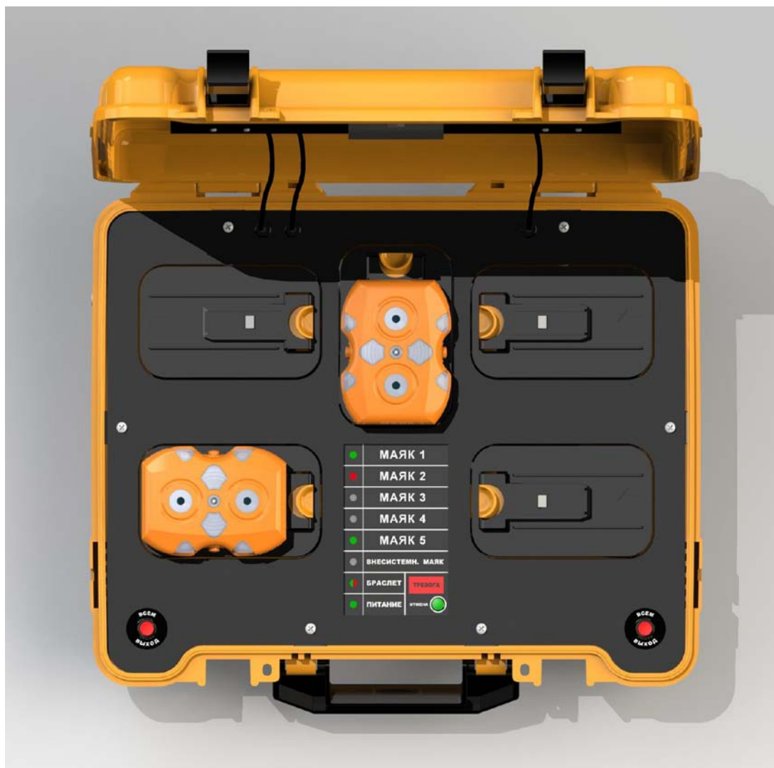
Рисунок А4-1 Пример состояния индикации МППС исполнения 1
