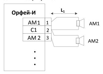
Ослабление звукового давления для AM1 и AM2 в этом случае при использовании медного провода сечением 0.75 мм<sup>2</sup> будет следующим:
