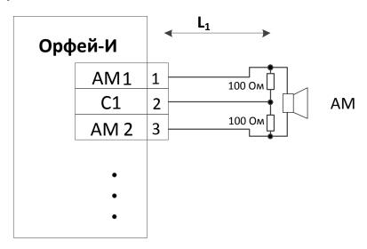
Подобное подключение позволяет в два раза повысить мощность, подводимую к АМ по сравнению с обычным вариантом подключения.
