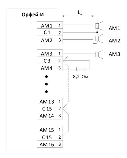
Особенностями данного варианта подключения является то, что AM1 и AM2 расположены в непосредственной близости, что позволяет использовать трехпроводной кабель с средним проводом "нулевой/земля" (например, КПСЭнг-FRLS 2x0.75).
