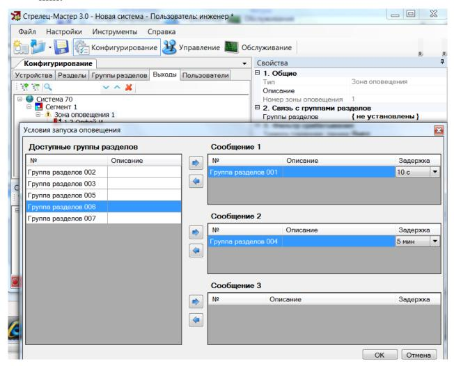
5. Выполнить программирование свойств Орфей-И в КСГ стандартным способом согласно руководству по эксплуатации интегрированной системы безопасности "Стрелец-Интеграл" СПНК 425513.039 РЭ.
