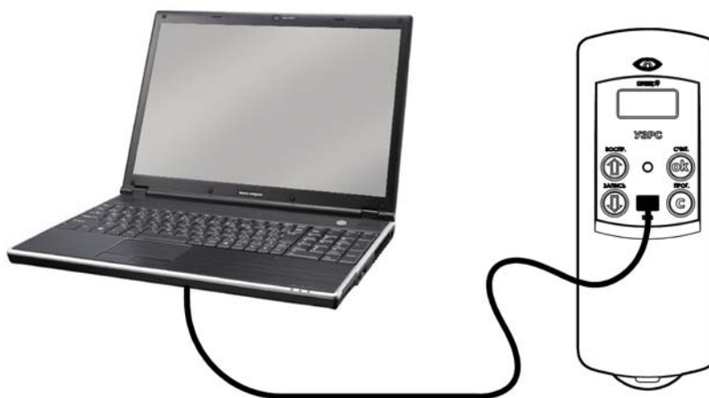
Рисунок 8 Схема подключения к ПК по USB
