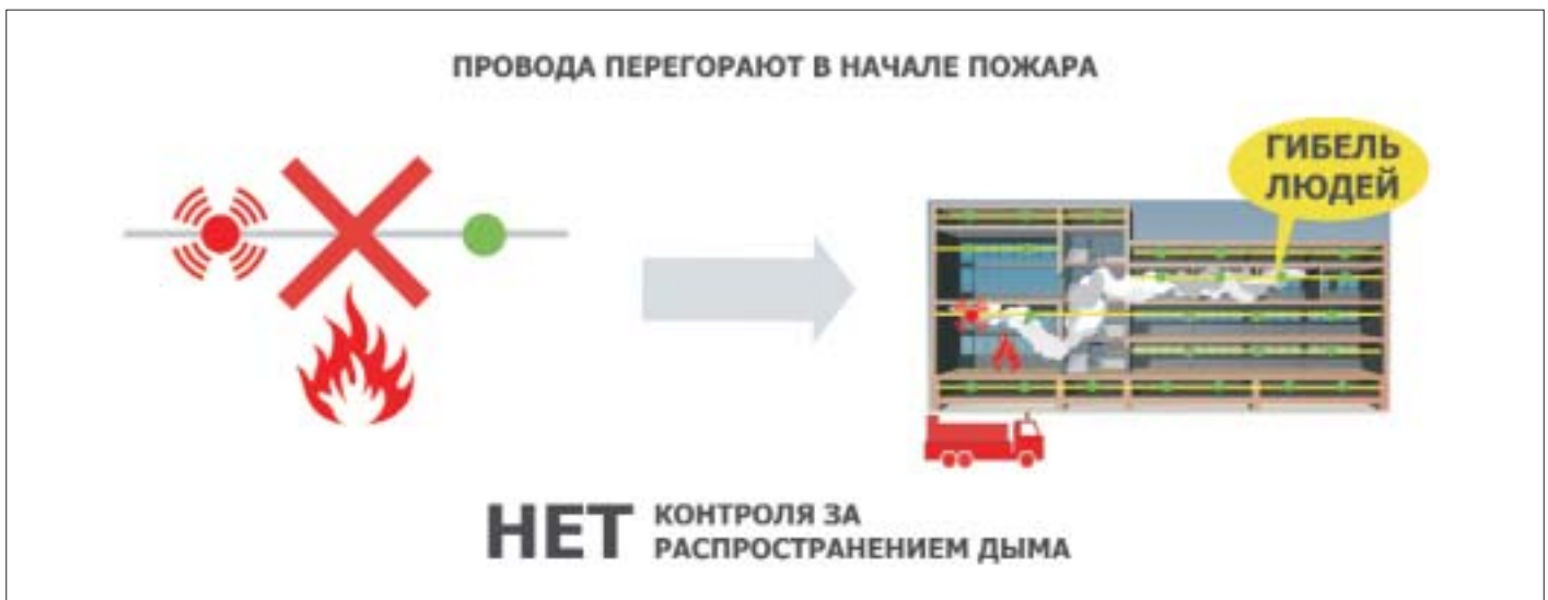
Рис. 2. Проводные системы выходят из строя в начале пожара
