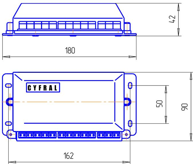
Рисунок А.3. Установочные и габаритные размеры коммутатора ЦИФРАЛ ИНТЕЛ КМГ-100И и адаптера телефонной сети ЦИФРАЛ ИНТЕЛ ГТС
