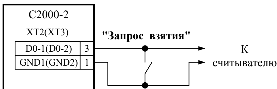
Рисунок 7 Подключение кнопки "Запрос взятия"
