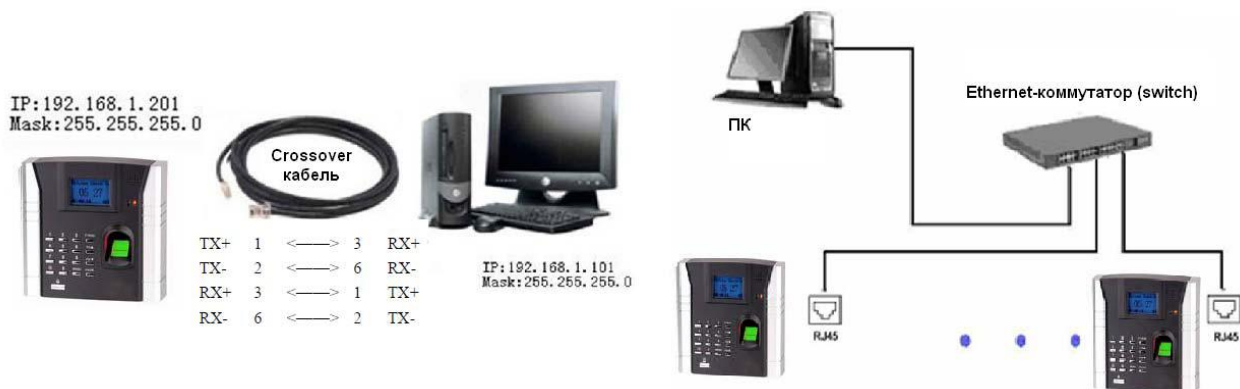
Рисунок 7. Подключение контроллеров по интерфейсу Ethernet
