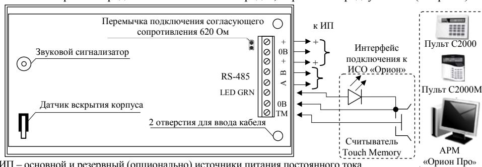
Рисунок 3. Схема внешних соединений блока
