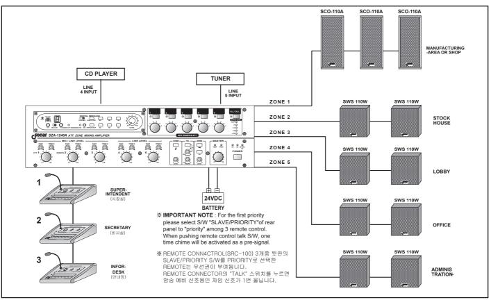
\* Важное замечание: Для выбора высшего приоритета одной из микрофонных консолей установите переключатель SLAVE/PRIORITY на задней панели нужной консоли в положении PRIORITY. При однократном нажатии клавиши на микрофонной консоли прозвучит предупреждающий сигнал.
