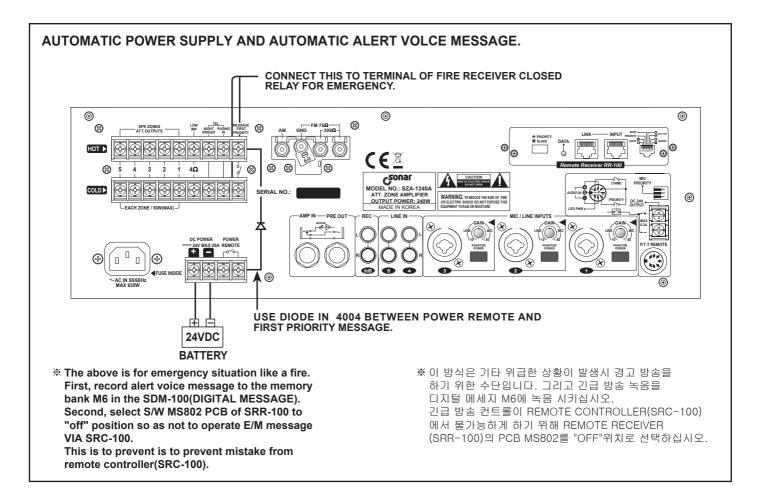
\* Данная схема приведена для аварийной ситуации, такой как пожар. Запишите голосовое сообщение в блок сообщений SDM-100 (DIGITAL MESSAGE) (ячейка M6). Установите переключатель MS802 на плате PCB SRR-100 в положение OFF так, чтобы не передавать аварийное сообщение через SRC-100. Это делается с тем, чтобы исключить ложную тревогу при работе с дистанционным контроллером (SRC-100).
