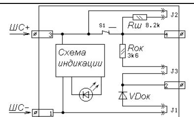
**Включение извещателя в шлейф сигнализации со знакопеременным напряжением с квитированием приборов типа УСПП-01Л "Сигнал-42-01" или аналогичных.**
