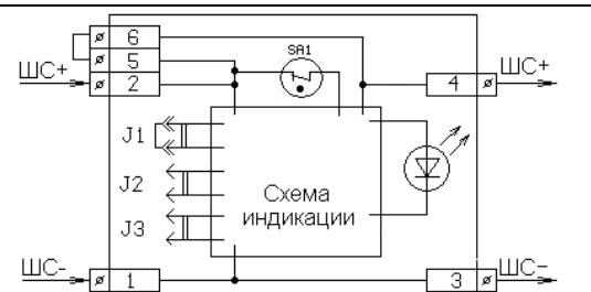
**Извещатель с нормально-замкнутым контактом в шлейфе сигнализации без квитирования.**
