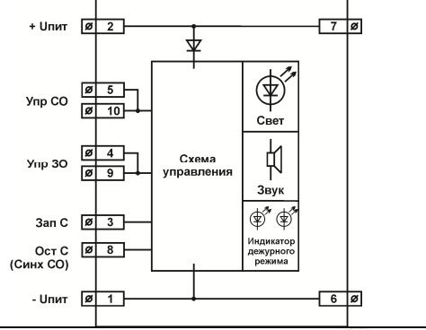
Управляющий сигнал может формироваться прибором управления, имеющим выход в виде контактов реле, открытого коллектора/стока или TTL/CMOS совместимый.
