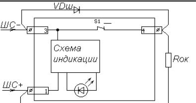
**Включение извещателя в шлейф сигнализации без квитирования приборов типа "Нота", "Радуга" и аналогичных.**
