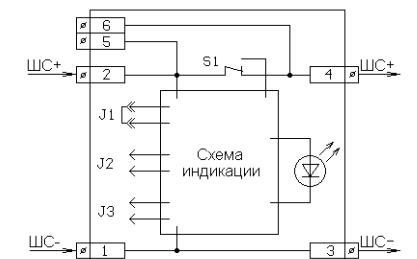
**Извещатель с нормально-замкнутыми контактами в шлейфе сигнализации со знакопеременным напряжением с квитированием.**
