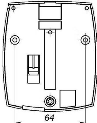
Проведите провода через нижнее отверстие основания и закрепите розетку извещателя на месте эксплуатации.
