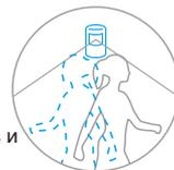
Датчик повторно сможет послать сигнал контрольной панели после того, как встанет снова под охрану. Датчик реагирует на движение, отправляет сигнал контрольной панели и уходит в спящий режим на 3 минуты. В течении этого времени, датчик не реагирует на движение.
