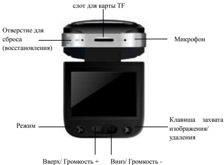
**Клавиша смены режима:** для перехода к видеозаписи, фотосъемке и просмотру, а также установок системы. В режиме просмотра нажмите MODE для входа в статус просмотра по 6 фотографий на экране.
