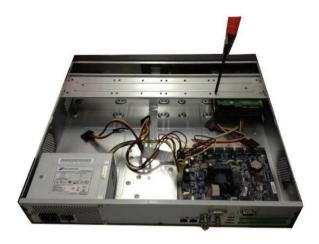
Положите HDD на кронштейн HDD , а затем совместите четыре винта с четырьмя отверстиями в HDD. Используйте отвертку, чтобы прикрутить винты, и закрепить жесткий диск на кронштейне HDD
