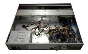
Соедините кабель данных HDD (жесткого диска) с основной платой и портом HDD (жесткого диска) соответственно. Ослабьте кабель питания корпуса и подключите другой конец кабеля питания к порту HDD.
