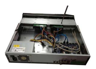
Положите HDD на кронштейн HDD, а затем совместите четыре винта с четырьмя отверстиями в HDD. Используйте отвертку, чтобы прикрутить винты, и закрепить жесткий диск на кронштейне HDD
