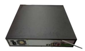
Используйте отвертку, чтобы освободить болты задней панели, далее снимите верхнюю крышку.
