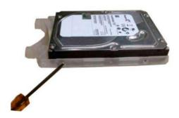
2. Используйте отвертку, чтобы зафиксировать ручку на HDD.
