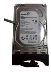
Используйте четыре винта, чтобы закрепить HDD
