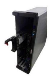
Поместите HDD в корпус на передней панели устройства
