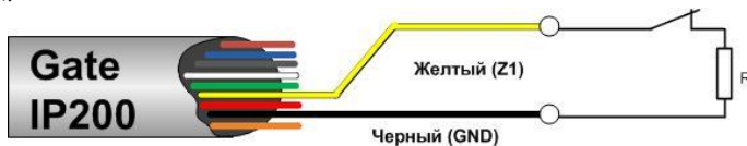
Рис.12. Подключение дверного контакта
