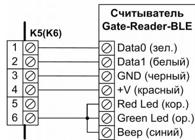
Для подключения рекомендуется кабель UTP сечением каждого провода не менее 0,22 мм<sup>2</sup>. Сигналы DATA 0 и DATA 1 рекомендуется передавать в отдельных повитых парах с замыканием второго повивающего проводника на GND контроллера СКУД.
